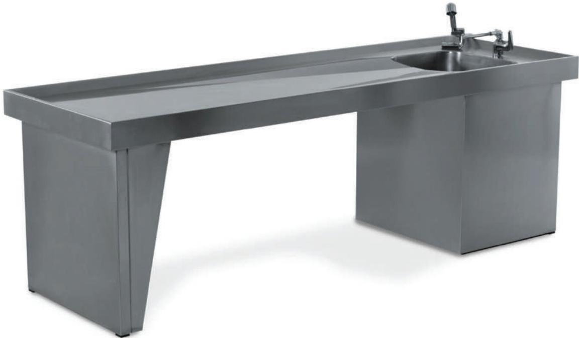
Table anatomique pour autopsie, complètement en acier inox Aisi 304, composée d'un plan d'appui opportunément incliné pour l'écoulement des eaux et bords périmétraux de confinement.
